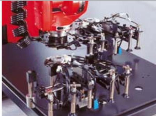
Mit mehr Bewegungsfreiheit kann der Be- und Entladeroboter den automatischen Greiferwechsel selbstständig ansteuern.
