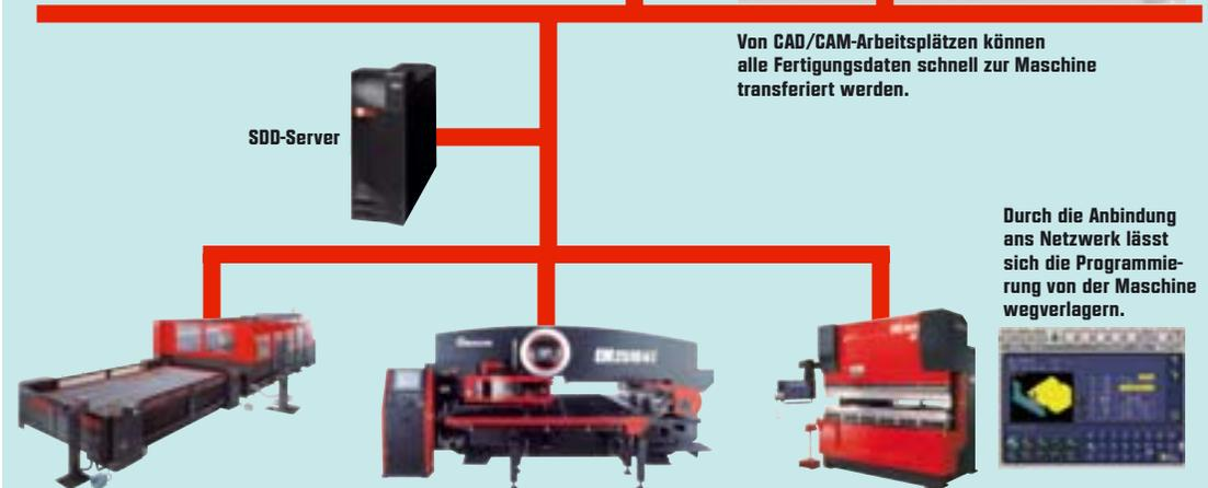
Von CAD/CAM-Arbeitsplätzen können alle Fertigungsdaten schnell zur Maschine transferiert werden.
