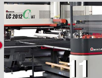
Stanzen und Laserschneiden: LC-2012 C1 NT
