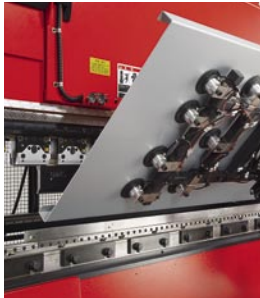
Für maßgenaue Werkstücke unterstützt der Biegeroboter den Abkantvorgang durch eine auf den Pressbalken abgestimmte Aufwärtsbewegung.
