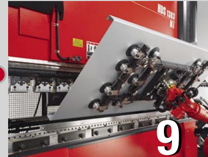
Abkanten: ASTRO-165 W – Biegezelle für große und/oder schwere Werkstücke
